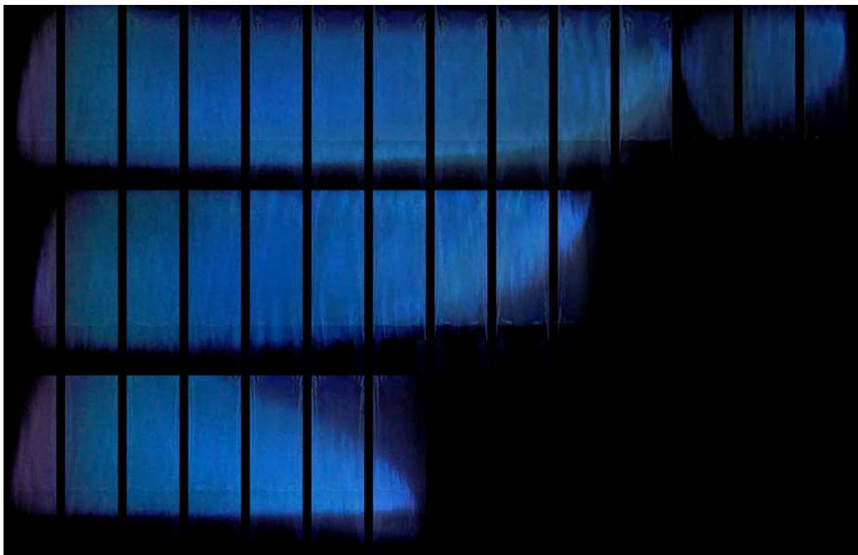
Obr. 6: Snímek zobrazuje vývoj vertikální polohy zaznamenaný vysokorychlostní kamerou. Horní obrázek odpovídá křivce se stabilizací a proudem 98 A, střední bez jakékoliv stabilizace a spodní se stabilizací a proudem 205 A.
