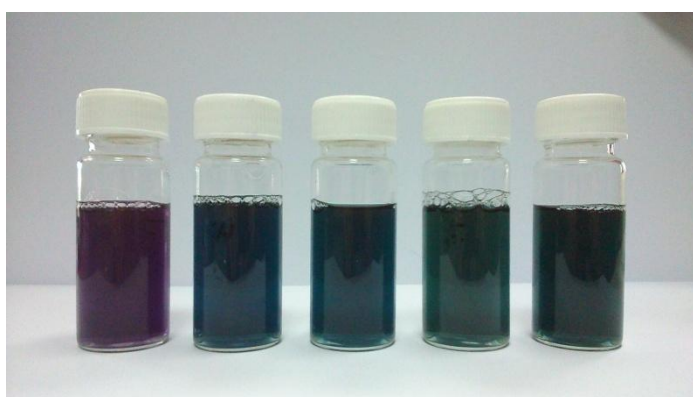
Obrázek 5 - Vzorky koloidních roztoků seřazené zleva doprava od nejmenšího podílu stříbra po největší
